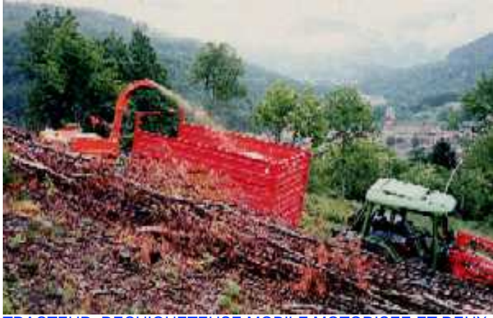
TRACTEUR, DECHIQUETEUSE MOBILE MOTORISEE ET DEUX REMORQUES DE TRANSPORT ET DE DECHARGEMENT
